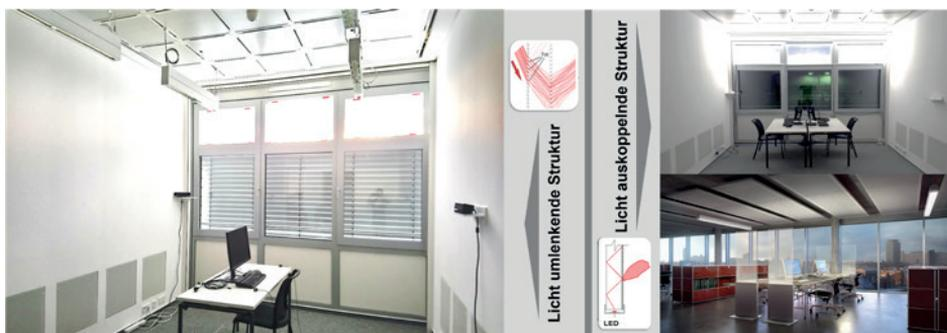
Abbildung 1: Tageslichtlenkende Fassade im Versuchsraum (l.), Kunstlicht aus der Fassade im Versuchsraum (u. r.) und Anwendungsszenario als Stehleuchte (u. r.), [Quellen: Fotos: Fraunhofer IBP, Grafik des Anwendungsszenarios: SSP AG]
