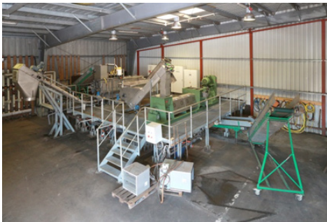
Abb. 1 (links): Wasch- und Konditionierungstrecke der Versuchs- und Demonstrationsanlage der Firma Bi.En (Foto: Bi.En)
