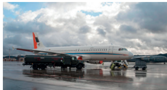
Abbildung: Betankung des Airbus A320 ATRA mit alternativen Treibstoffen (© DLR (CC-BY 3.0)).
