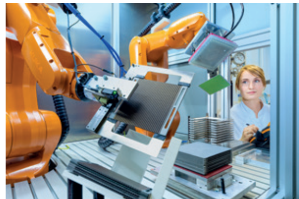
Abbildung: Applikations- und Stapelmaschine für SOC-Stacks (© Fraunhofer IKTS)
