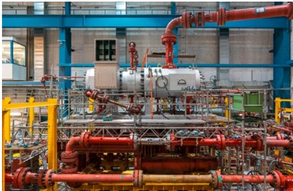
Wärmepumpen-Prüfstand von MAN Energy Solutions.
