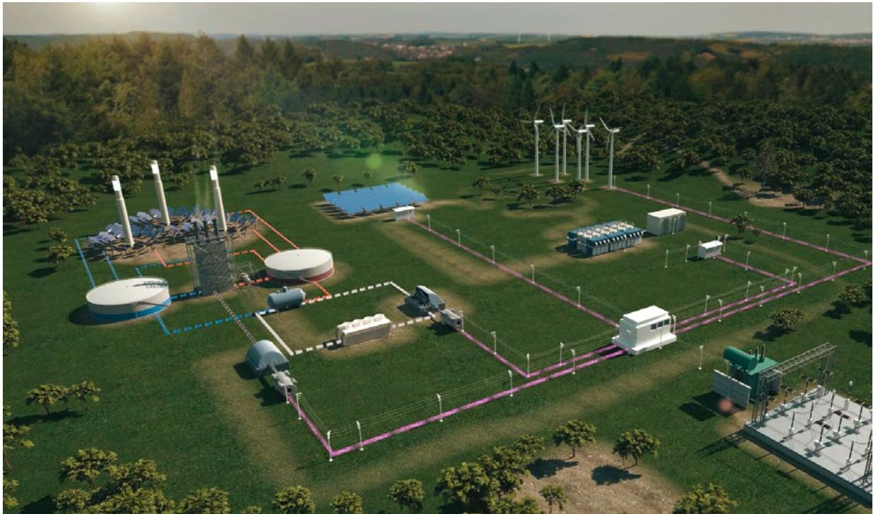
Modell eines klimafreundlichen Energiesystems mit CSP-, PV- und Windenergie-Anlagen sowie Speichern und einem fossilen Backup-System, sodass auch in Windflauten und Sonnepausen bedarfsgerecht Strom ins Netz eingespeist werden kann.
